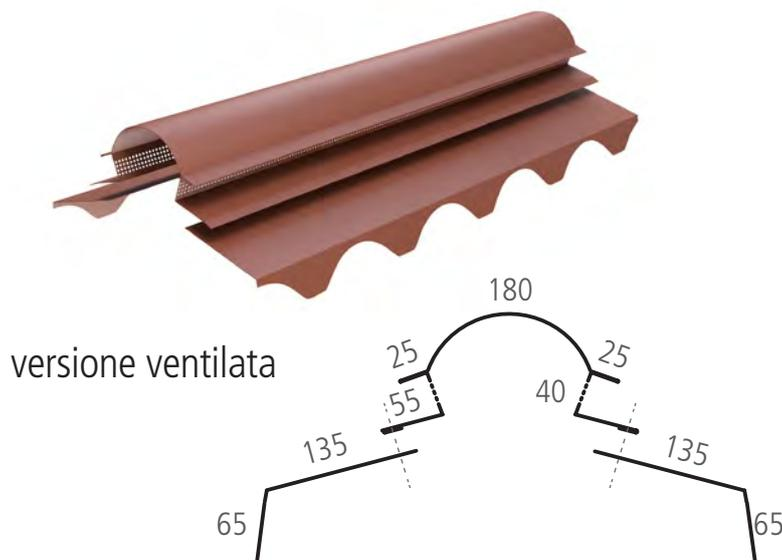
Da utilizzarsi al vertice di due falde, possiede la sagomatura dentellata per la chiusura delle ondulazioni. Trattandosi di un elemento a cerniera costituito da due pezzi, permette una più regolare posa in quanto non è necessario che le due falde contrapposte siano perfettamente simmetriche.
