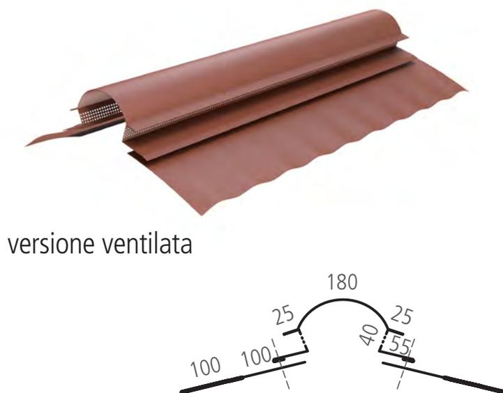
Da utilizzarsi per la congiunzione delle falde, sia di vertice che diagonale. È composto da una parte centrale e da due grebiuline laterali microcorrugate in materiale speciale, che consentono un adattamento manuale a qualsiasi forma di greca, con qualsiasi pendenza o angolazione.
